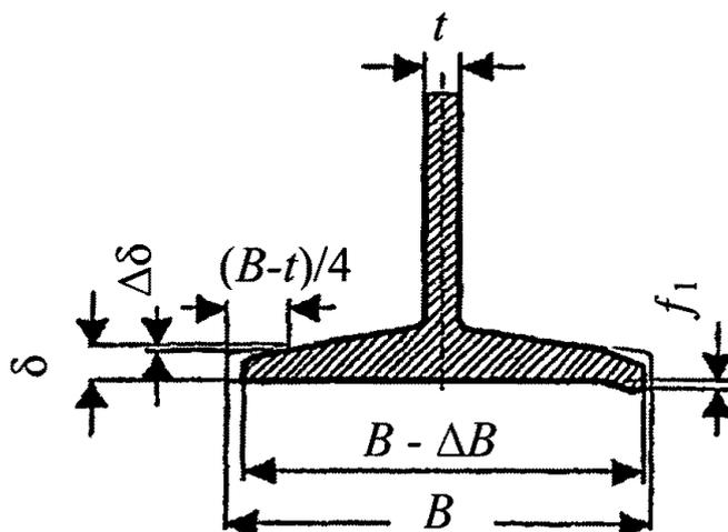
$B$  - первоначальная ширина полки;  $\Delta B$  - износ полки;  $t$  - толщина стенки;  $f_1$  - отгиб полки;  $\delta$  - первоначальная толщина полки на расстоянии  $(B - t) / 4$  от края;  $\Delta\delta$  - уменьшение толщины полки вследствие износа.
