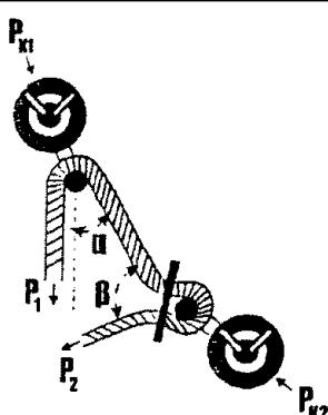
Через два карабина и устройство для спуска по канату
