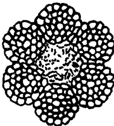
Рисунок 8. Уменьшение площади поперечного сечения проволок
