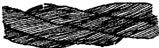
Рисунок 1. Обрывы и смещения проволок каната
