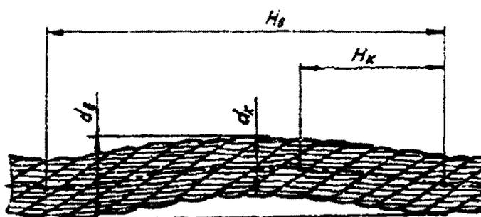
Рисунок 9. Волнистость каната
