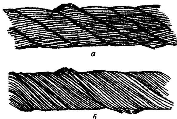
Рисунок 2. Сочетание обрывов проволок с их износом:
