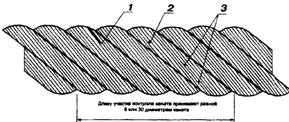
Рисунок 4. Пример определения числа
