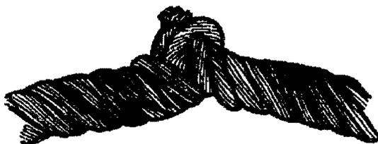
Рисунок 15. Перекручивание каната
