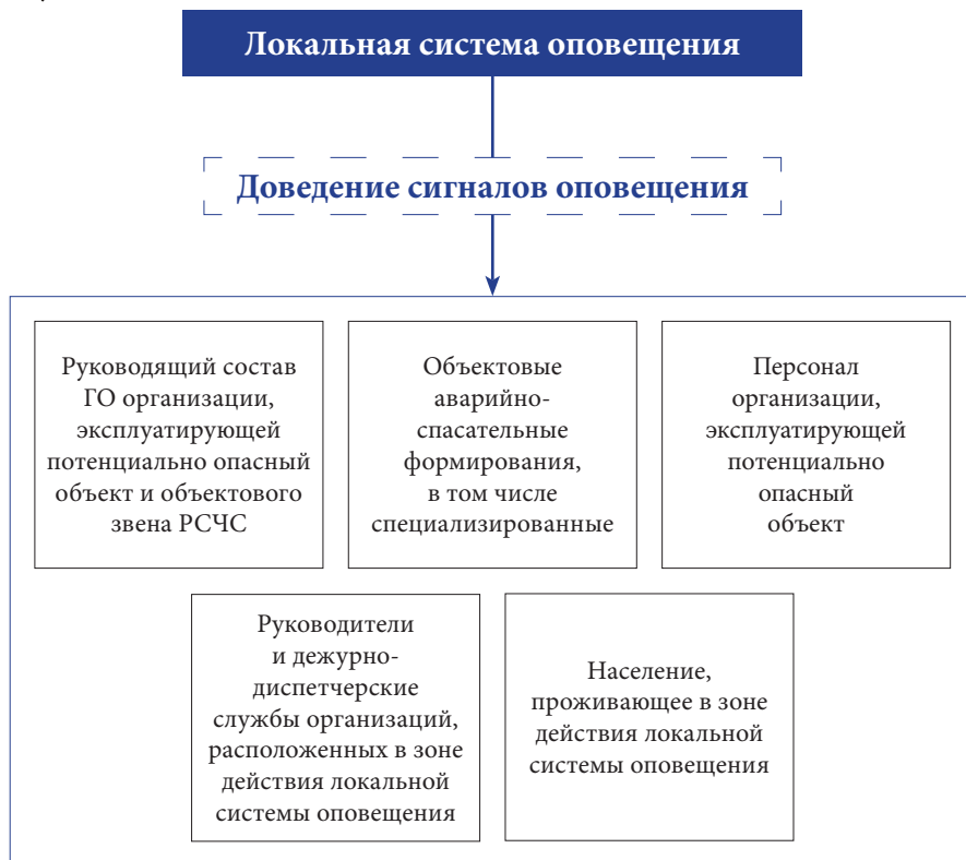
Рисунок 2.5 — Предназначение локальной системы оповещения
